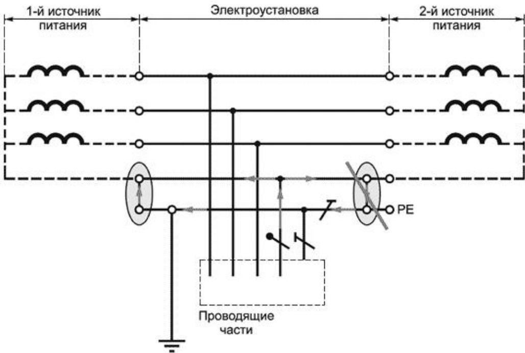
Рисунок 44.R7A - Система TN-S с несколькими источниками питания и с недопустимым многократным соединением между PE-проводником и землей
