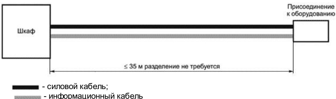
**Рисунок 44.R17A - Разделение силовых кабелей и кабелей информационных технологий при длинах кабельной трассы  $\leq 35 \text{ м}$**
