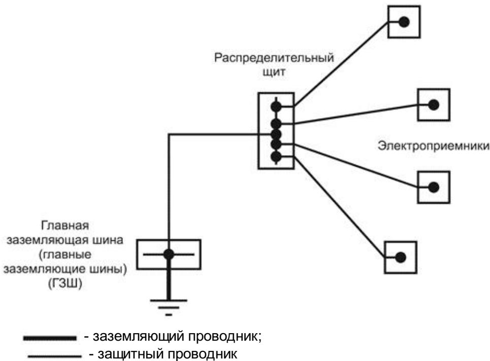
Рисунок 44.R13 - Примеры радиального соединения защитных проводников
