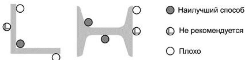
**Рисунок 44.R21 - Расположение кабелей внутри элементов металлических конструкций**
