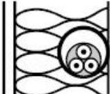
Комната  | Многожильные кабели в трубах, проложенных в термоизолирующих стенах <sup>a), c)</sup>                                                                                                  | A2                                                                                  |
