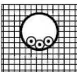
Изолированные провода или одножильные кабели в трубе в кладке (бетоне)<sup>р)</sup>
