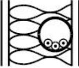
Комната  | Изолированные провода или одножильные кабели в трубах, проложенных в термоизолирующих стенах <sup>a), c)</sup>                                                                         | A1                                                                                  |
