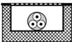
Бронированные одножильные или многожильные кабели в открытых или вентилируемых кабельных каналах, вертикальных или горизонтальных<sup>и)</sup>
