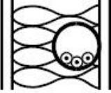
Комната  |  | A1 Изолированные проводники (одножильный кабели) в трубе в теплоизолированной стене |  | B.52.2, графа 2           |  | B.52.4, графа 2      |                      | B.52.3, графа 2                  |  |
