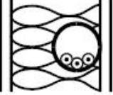
Комната |  | A2 Многожильный кабель в трубе в теплоизолированной стене                           |  | B.52.2, графа 3           |  | B.52.4, графа 3      |                      | B.52.3, графа 3                  |  |
